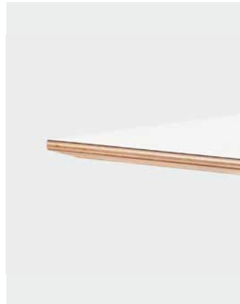
Kante H Tischplatte 20 mm stark, Trägermaterial Buche-Multiplex, R 3 mm nach unten abgeschrägt
