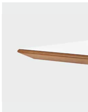
Kante J Tischplatte 30 mm stark, Trägermaterial MDF, R 9,5 mm nach unten abgeschrägt
