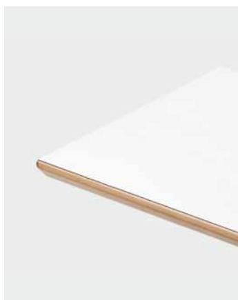
Kante I Tischplatte 20 oder 30 mm stark, Stirnseite Buchen-Massivholz-Anleimer 30/5 mm oben und unten mit Fasse, Längsseite Buchen-Massivholz-Anleimer nach unten abgeschrägt
